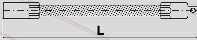
Гибкий удлинитель применяется для работы в труднодоступных местах при свободном вращении крепежа. Данное изделие категорически запрещается применять для начального ослабления и затяжки резьбовых соединений.
